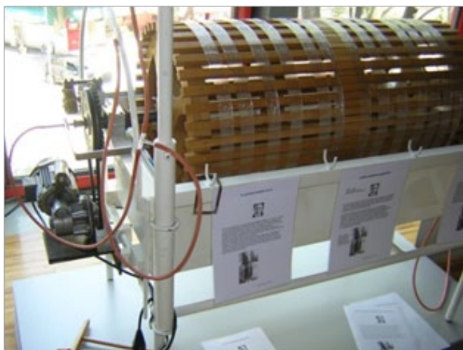
Model sztucznej nerki Willema Kollfa: po raz pierwszy wykorzystano zjawisko fizyczne dyfuzji do ratowania chorych zagrożonych mocznicą
