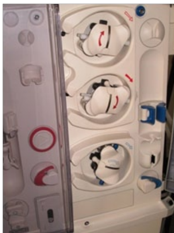
Praca na dwie pompy... Ta górna, pompa krwi. Ta dolna – pompa restytucyjna ultrafiltratu. Ich równoczesna praca oznacza istotną, jakościową poprawę skuteczności dializowania dzięki uruchomieniu klirensu konwekcyjnego i wspierającego go klirensu dyfuzyjnego
